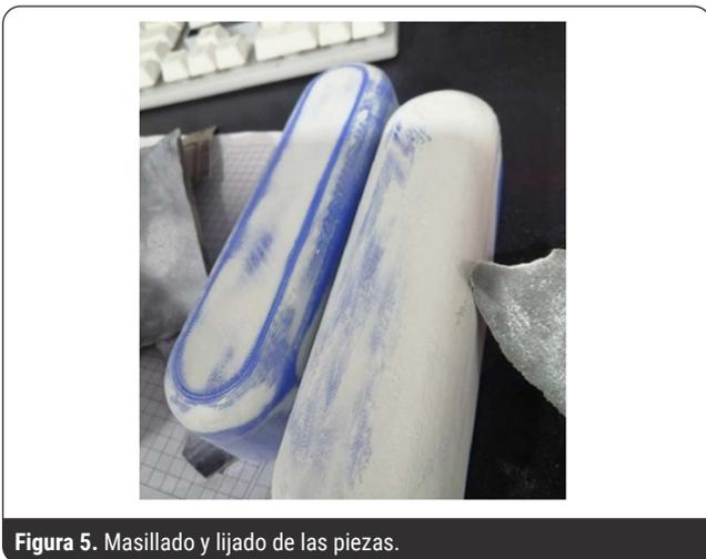
Figura 5. Masillado y lijado de las piezas.
